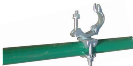
**Анкерный кронштейн** - служит для крепления строительных лесов. Крепление конструкции лесов к стене происходит с помощью анкерных кронштейнов. Регулируемый размер кронштейна составляет 280-340 мм.
