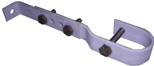
**Анкерный кронштейн удлинённый** - применяется для крепления лесов к стене, где необходим большой зазор конструкции лесов от облицовочного фасада здания. Регулируемый размер удлинённого кронштейна составляет 280-840 мм.
